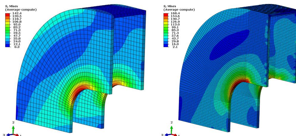
Figura 7.22. A sinistra: stress di Von Mises per il rinforzo a U del modello grossolano; a destra: Stress di Von Mises per il sottomodello del rinforzo a U.
